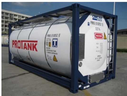
Figure 2 : Photographie d'un conteneur-citerne (1001containers.fr)
