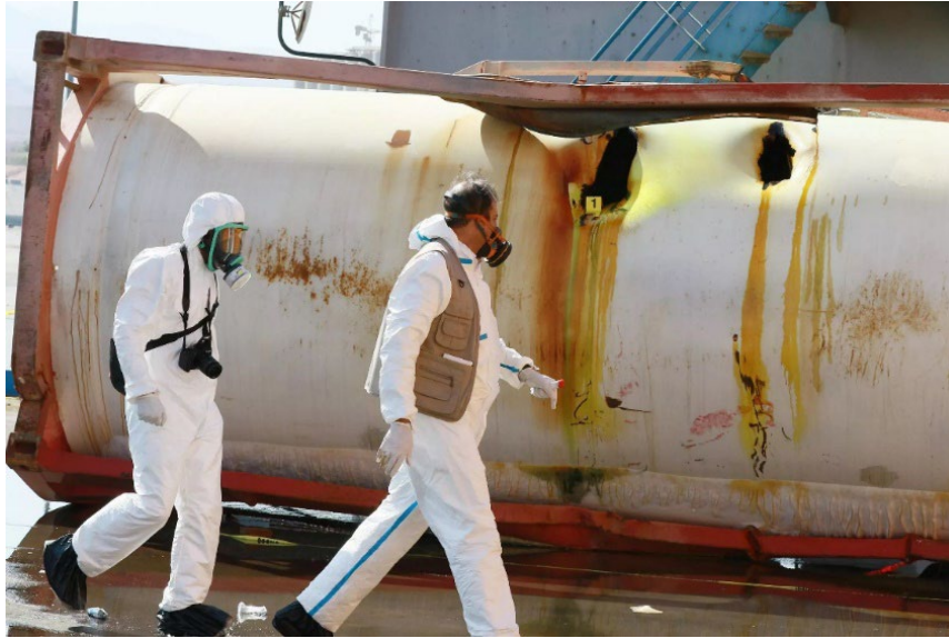
Figure 14 : Les avaries sont visibles sur le fond en partie gauche de la citerne (AFP - KHALIL MAZRAAWI)
