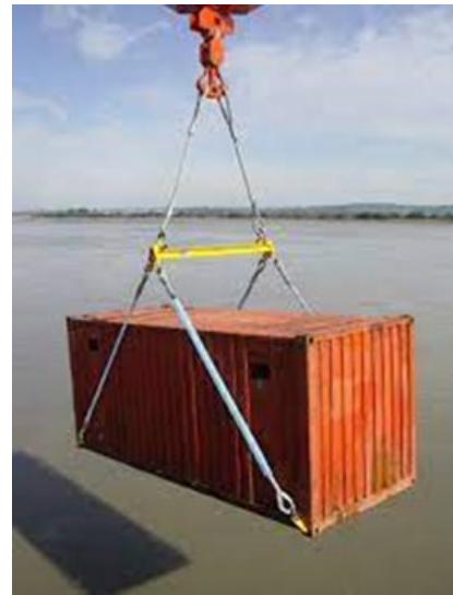
Figure 17 : Suspension par deux élingues reliées à un palonnier ( \alpha < 90^\circ ). Le croc de la grue est identique à celui de la grue portuaire d'Aqaba (Prévention Btp.fr)
